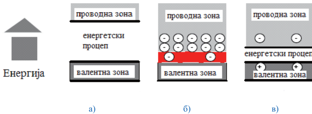
Сл. 5.2.1. Шематско прикажување на енергетските зони: а) изолатор, б) проводник, в) полупроводник.
